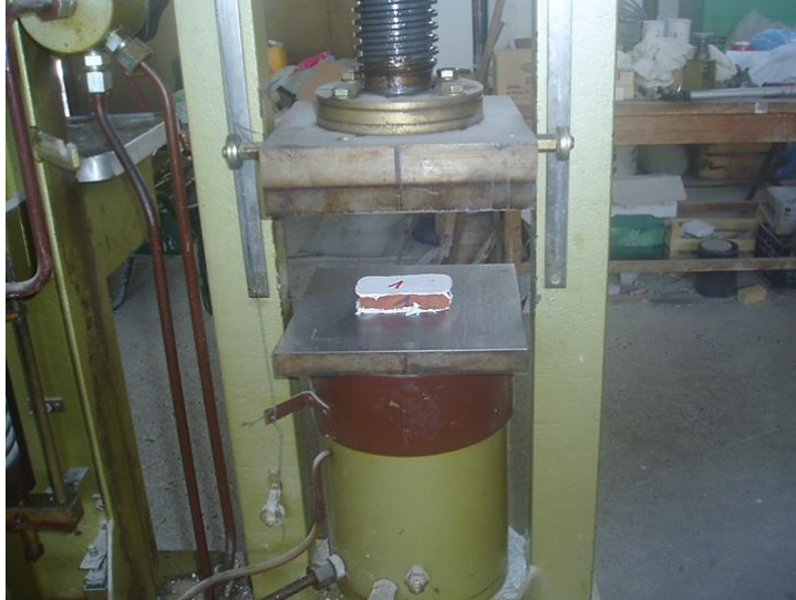
Slika 14. Presa tipa HPN400, Laboratorija Građevinskog fakulteta u Podgorici
